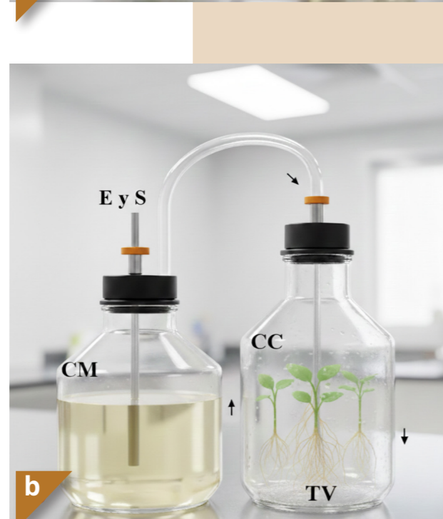
Figura 1. Biorreactores de frascos gemelos. a) De flujo y reflujo y b) Biorreactor de Inmersión Temporal. CC: cámara de cultivo, CM: cámara de medio de cultivo, F: filtro, E: entrada de aire, S: salida de aire y TV: tejido vegetal.
