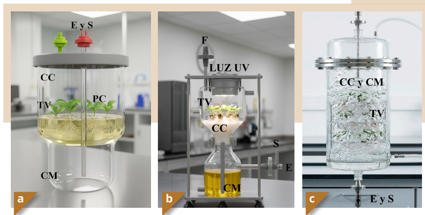
Figura 2. Biorreactores de un solo contenedor. a) Recipiente Automatizado de Inmersión, b) Termofotobiorreactor y c) Biorreactor de Inmersión por Burbujas. CC: cámara de cultivo, CM: cámara de medio de cultivo, F: filtro, E: entrada de aire, S: salida de aire, TV: tejido vegetal y PC: puerto central.
