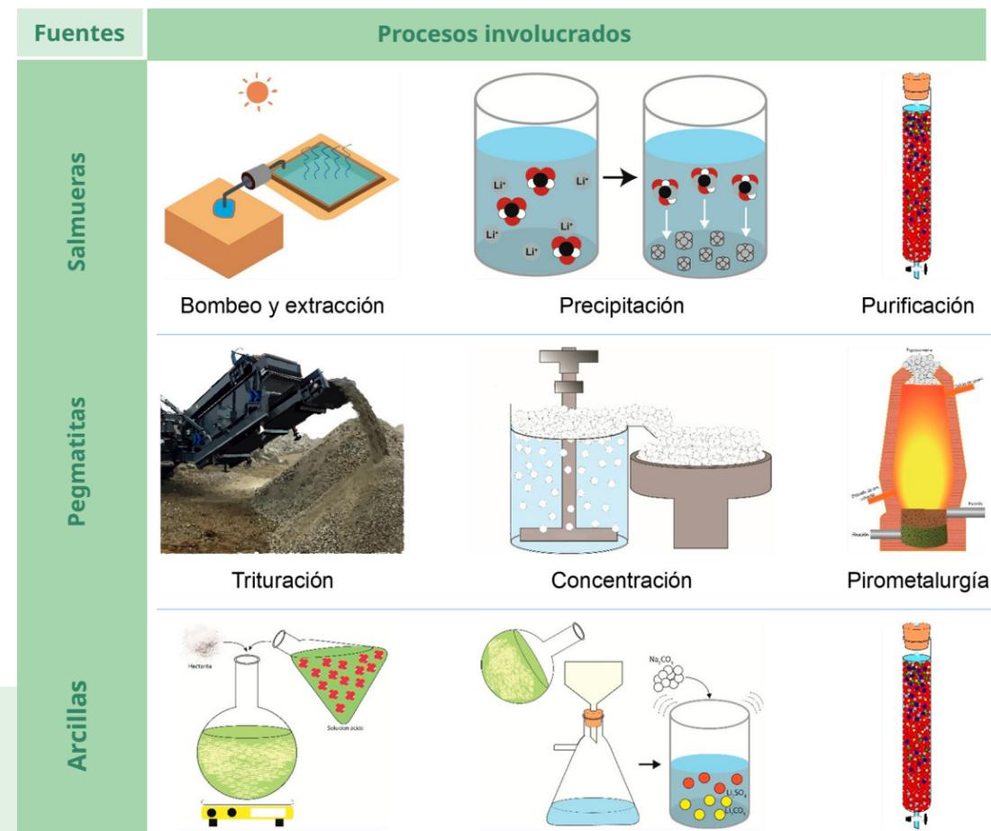
Figura 5. Procesos involucrados en la extracción de litio a partir de diversas fuentes.
