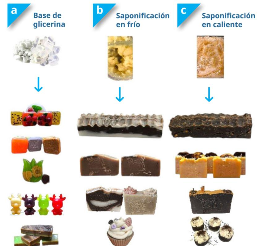
**Figura 2.** Tres tipos de jabones artesanales elaborados con distintas técnicas: a) base de glicerina, b) saponificación en frío y c) saponificación en caliente. Las diferencias en textura, firmeza, color y brillo reflejan el impacto del método de elaboración. Los jabones de glicerina, por ejemplo, muestran colores más intensos y acabados brillantes. Fuente: Elaboración propia.
