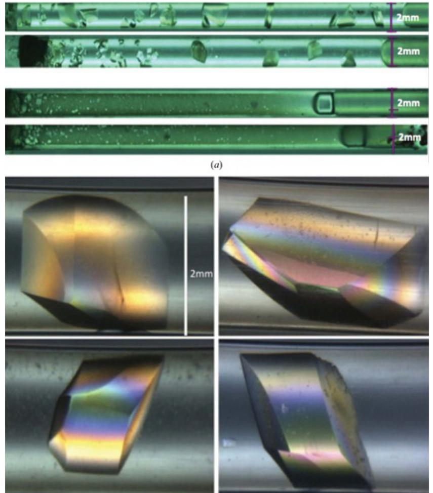
**Figura 1.** a) Crecimiento de un cristal de proteína en la microgravedad (arriba) y en la Tierra (abajo) bajo las mismas concentraciones y protocolos, dentro de tubos capilares de 2 mm de diámetro. b) cristales de proteínas obtenidas en la microgravedad vistas bajo luz polarizada. Imagen tomada de Ng, et al., 2015.
