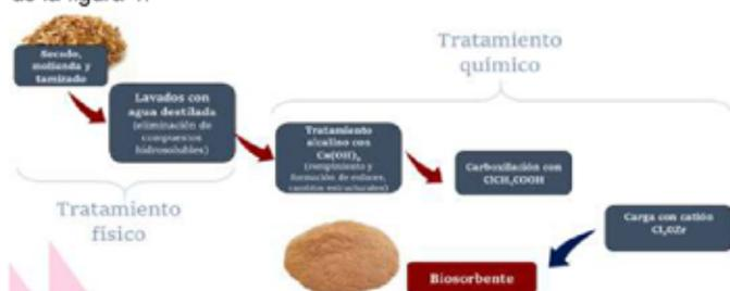
Figura 1. Preparación del biosorbente
