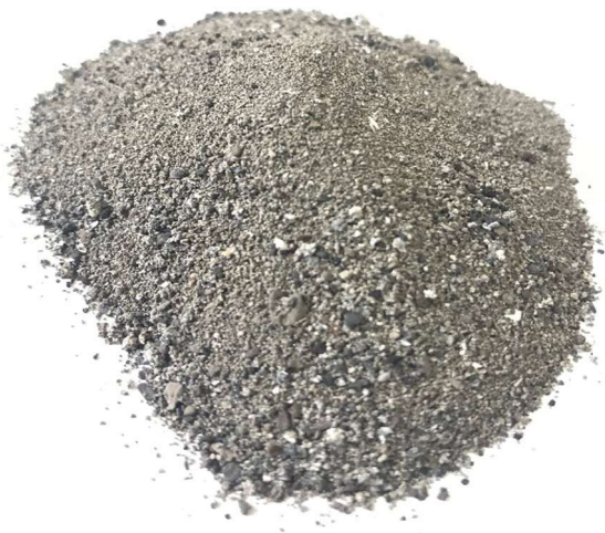
Figura 1. Aspecto de las cenizas de los lodos residuales, que en la actualidad se encuentran en estudio como fertilizante mineral por nuestro grupo de investigación.
