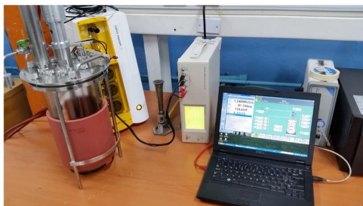
Figura 5. Ejemplo de sistema empleado para el monitoreo del cultivo por lote de Bacillus mediante espectroscopia dieléctrica.
