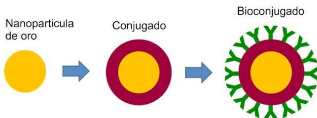
Figura 2. Diagrama esquemático del proceso de obtención de un bioconjugado fluorescente utilizando nanopartículas de oro.
