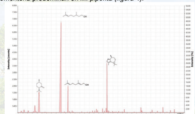
Figura 2. Espectro de CG-MS de Pelargonium citrodorum .
