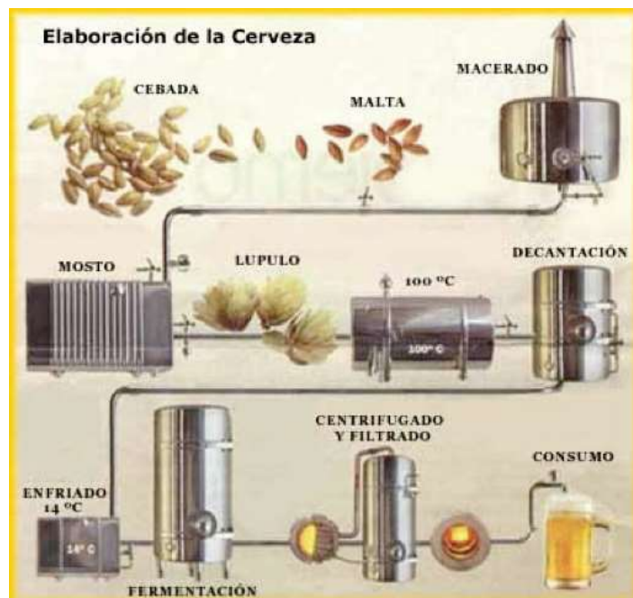
Figura 1. Proceso de elaboración de cerveza
